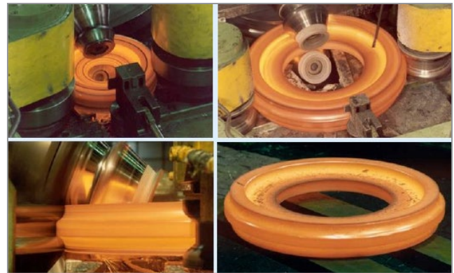
Рис. 9. Возможности кольцераскатки: a – номенклатура деталей для кольцераскатки; б – раскатка профильных колец
