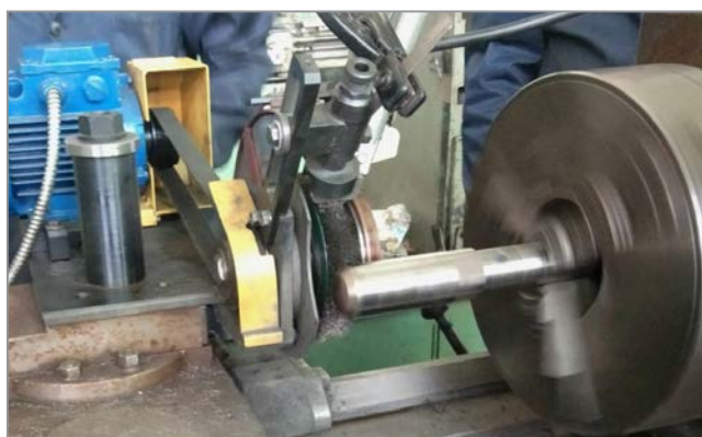
Рис. 5. Процесс нанесения покрытия на плунжер
