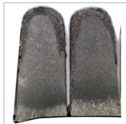
Рис. 40. Излом проб из серого чугуна СЧ20, обработанного модификатором
