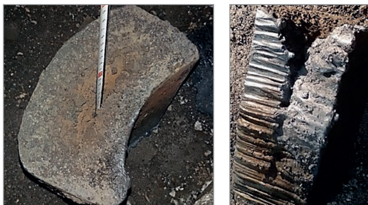
Рис. 39. Прибыльная часть отливки с использованием экзотермической смеси
