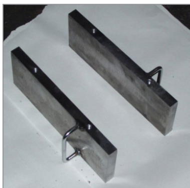
Рис. 20. Общий вид экспериментального кокиля и его составляющих
