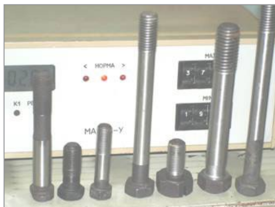
Рис. 14. Внешний вид электронного блока прибора МАКСИ-У и контролируемых болтов различных типов
