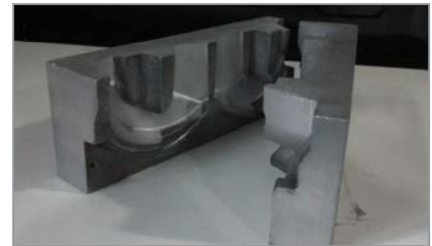
Рис. 27. Стержневая оснастка для производства отливки «Колесо турбинное»
