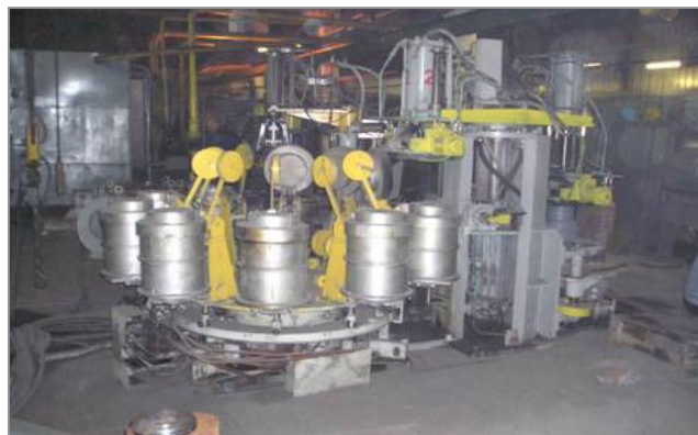
Рис. 18. Установка и оборудование для непрерывного литья намерзанием
