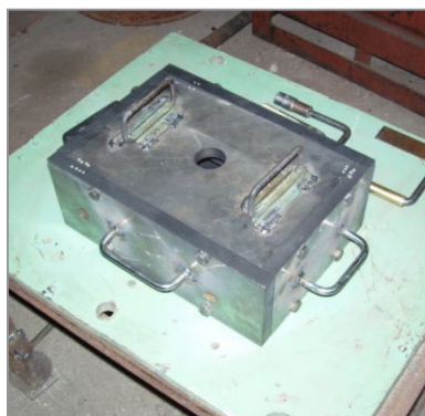
Рис. 20. Общий вид экспериментального кокиля и его составляющих
