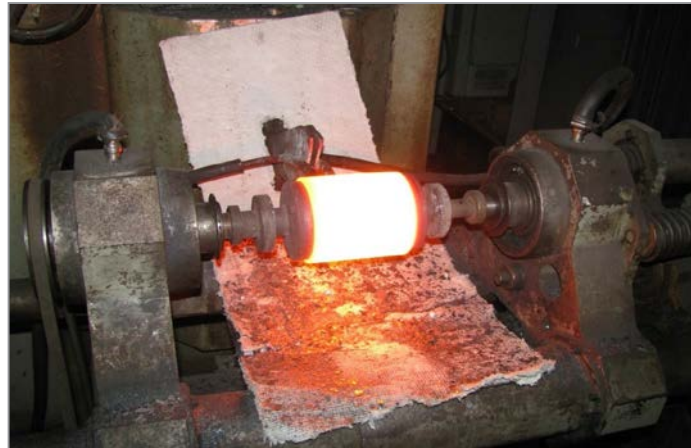
Рис. 8. Процесс центробежной индукционной наплавки износостойких антифрикционных покрытий из порошковых шихт с активирующими добавками
