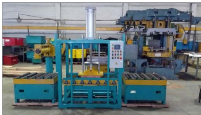
Рис. 23. Экспериментальный образец комплекса для изготовления стержневых пакетов, получаемых из песчано-смоляных смесей
