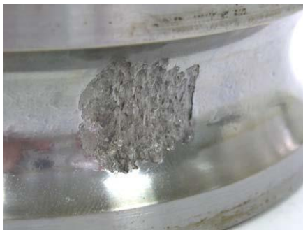
Рис. 9. Дефект на внутренней дорожке качения
