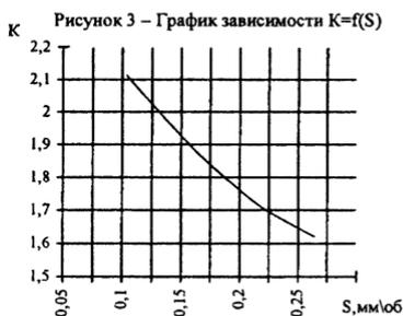
Условия эксперимента: материал заготовки – шарикоподшипниковая сталь ШХ15, широко применяемая в металлообработке, например, при изготовлении подшипников качения; инструмент – сборный резец с многогранной неперетачиваемой пластинкой (МНП), оснащенной канавкой для завивания стружки в спираль (материал МНП – двухкоробидный сплав Т15К6).
