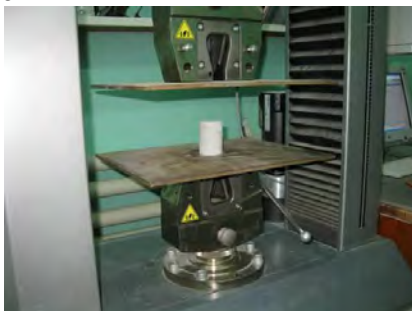
Рис. 13. Исследование свай на объекте: a – откопанная свая и уширение; б – керны, выбуренные из уширения; в – испытания кернов; г – испытанные образцы
