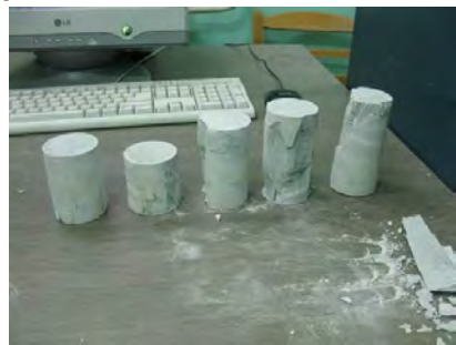
Рис. 13. Исследование свай на объекте: a – откопанная свая и уширение; б – керны, выбуренные из уширения; в – испытания кернов; г – испытанные образцы
