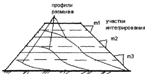
Рис. 1. Расчетная схема деформации и размыва тела плотины
