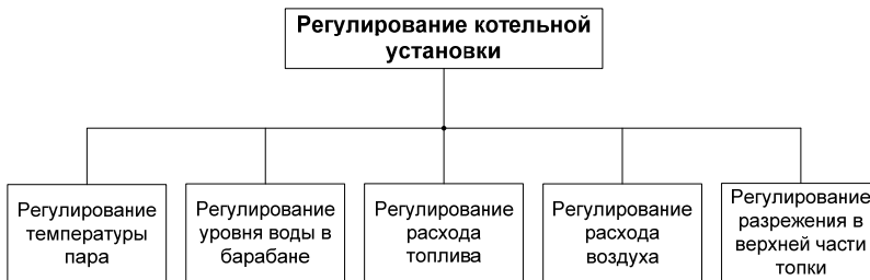
Рис. 2. Задачи комплексной системы регулирования котла.
