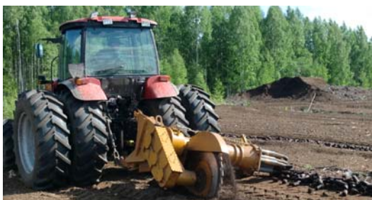
Рис. 1. Фрезерующе-формующий МТА с характеристиками: производительность, га/день – 1,5...2,5; рабочая скорость, км/час 0,9...2,5; привод от ВОМ, об/мин – 1000
