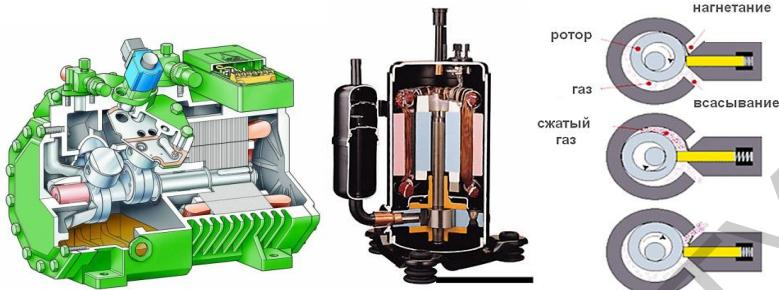
Ротационные компрессоры имеют небольшое число деталей, обладают простотой конструкцией, надежностью в эксплуатации, простотой обслуживания, хорошими массогабаритными показателями, относительно низкой стоимостью изготовления. Отсутствие клапанов на всасывании, а в некоторых типах и на линии нагнетания, снижает суммарные газодинамические потери.
