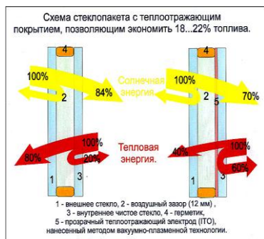
Рисунок 2 – Схема стеклопакета с теплоотражающим покрытием
