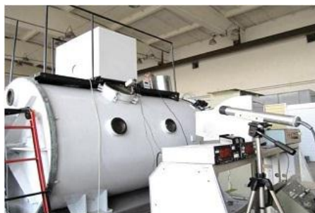
Рисунок 3 – Установка электронно-лучевой обработки
