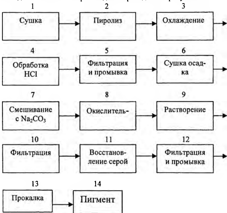
Рисунок 1 – Технологическая схема получения пигмента из хромосодержащих отходов кожевенного производства
