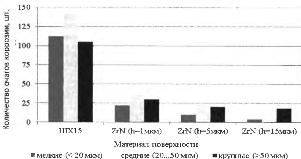
Рис. 7. Зависимость характеристик коррозии для стали ШХ15 от различной толщины покрытия ZrN при испытаниях в водопроводной воде по истечении 240 ч
