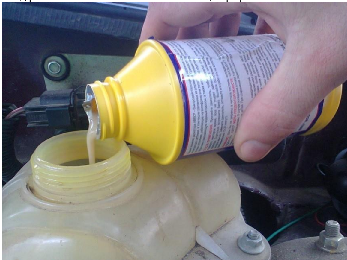
Рисунок 2 - Добавка герметика в охлаждающую жидкость
