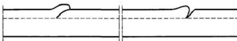
Рисунок 26- Плохое возобновление шва
