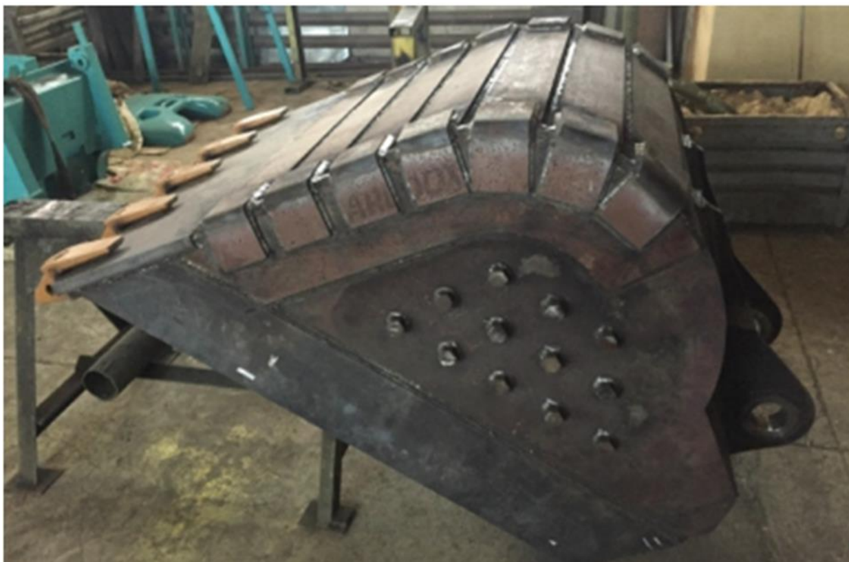
Рисунок 5 –Ковш при ремонте усилен специальными усиливающими накладками из износостойкой стали
