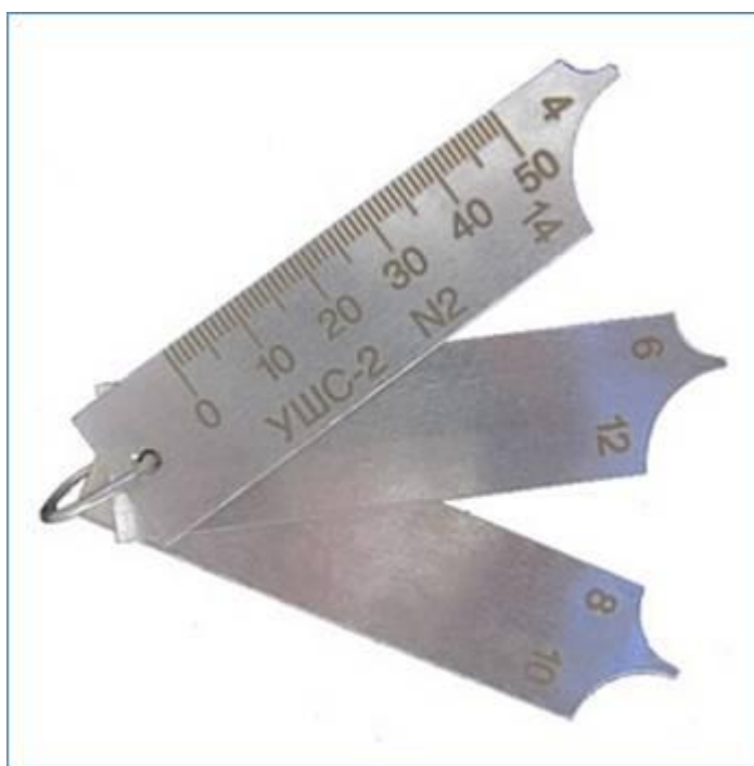
Рисунок 27 - Универсальный шаблон сварщика УШС-2
