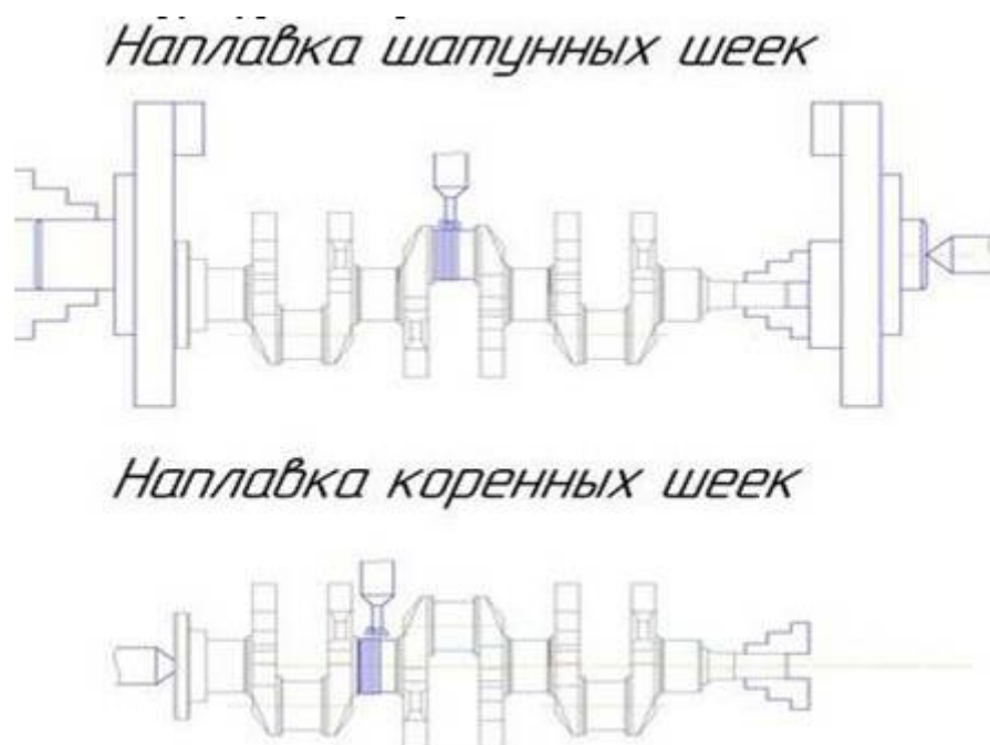
Рисунок 4 – Наплавка шатунных и коренных шеек коленчатого вала
