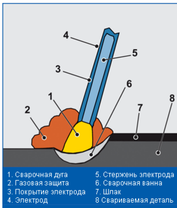
Рисунок 1 – Ручная дуговая сварка штучным электродом
