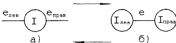
Рисунок 1.11 – Парциальные системы: а – одномассовая; б – двухмассовая
