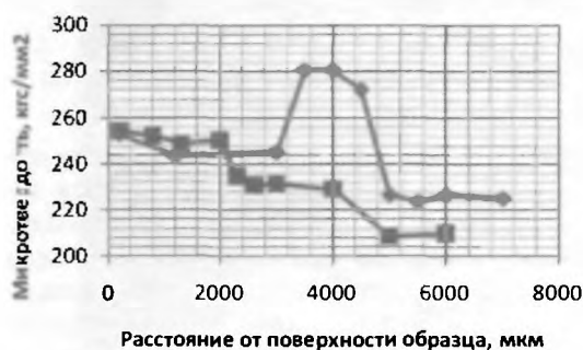
Рис. 2. Микротвердость в сечениях 1-1, 2-2 образца № 13: ряд 1 — поперечное сечение 1-1, от наплавки к центру стержня; ряд 2 — продольное сечение 2-2, от края поверхности к центру
