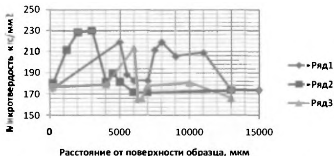
Рис. 6. Изменение микротвердости в сечениях 1-1, 2-2 образца № 54: ряд 1 — сечение 1-1, от шва к центру левого стержня; ряд 2 — сечение 1-1, от шва к центру правого стержня; ряд 3 — начало флангового шва, от шва к центру левого стержня
