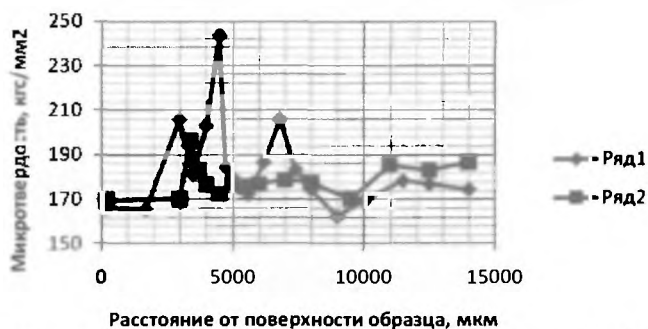
Рис. 5. Микротвердость в сечениях 1-1, 2-2 образца № 57-1: ряд 1 — сечение 1-1, от наплавки к центру стержня; ряд 2 — продольное сечение 1-1, от края к центру
