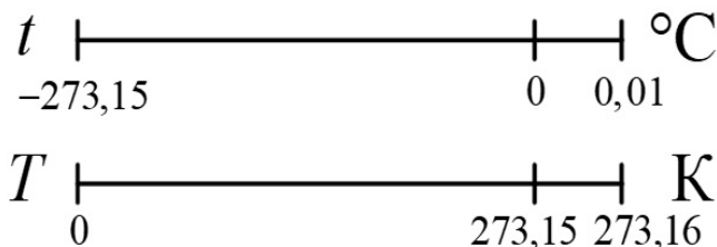
Рис. 2.3. Соотношения между температурными шкалами Цельсия и Кельвина
