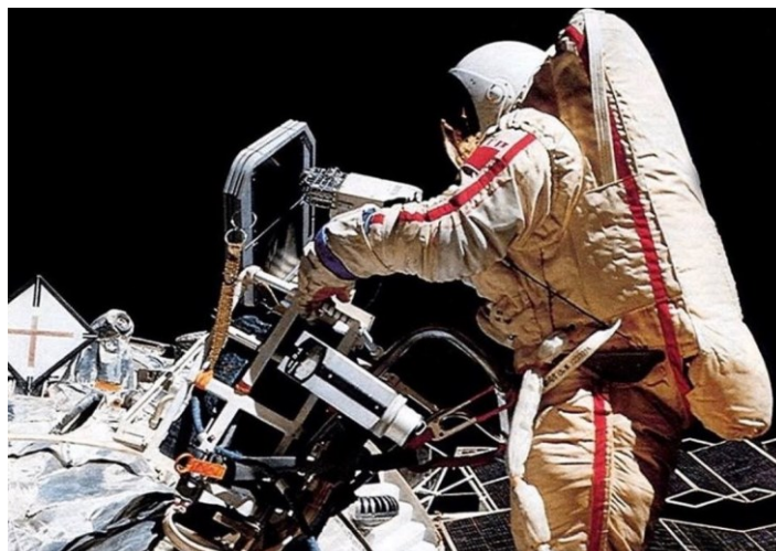
Рис. 2.17. Сварка в космосе
