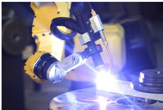
Рис. 2.16. Роботизированный комплекс электродуговой сварки неплавящимся электродом в инертном газе для ядерной энергетики
