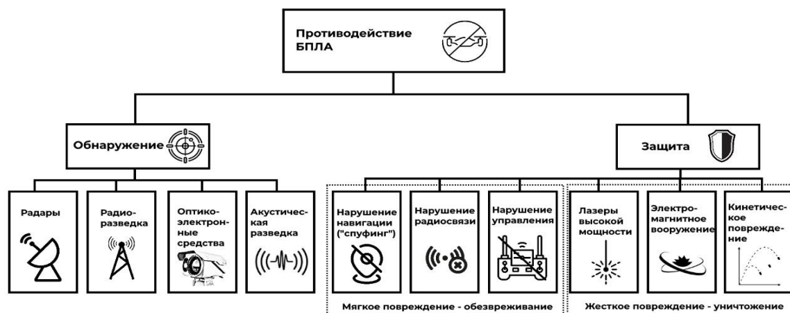
Рисунок 1 – Схема противодействия БПЛА
