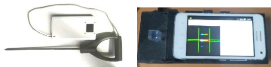
Рисунок 3 – Микропроцессорные датчики температуры, влажности почвы, качества воздуха и воды (ESP32 с модулями DHT22 (температура/влажность), датчики газа (MQ-135))
