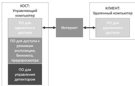
Рисунок 2 – Структурная схема удаленного доступа к средствам управления 2-D рентгеновской камерой
