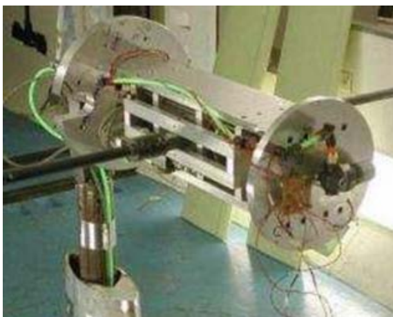
Рисунок 4 - Механизм стреловидности крыла с приводом от сильфонного привода
