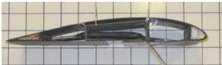
Рисунок 2 – Модель морфного крыла с приводом МакКибена без давления
