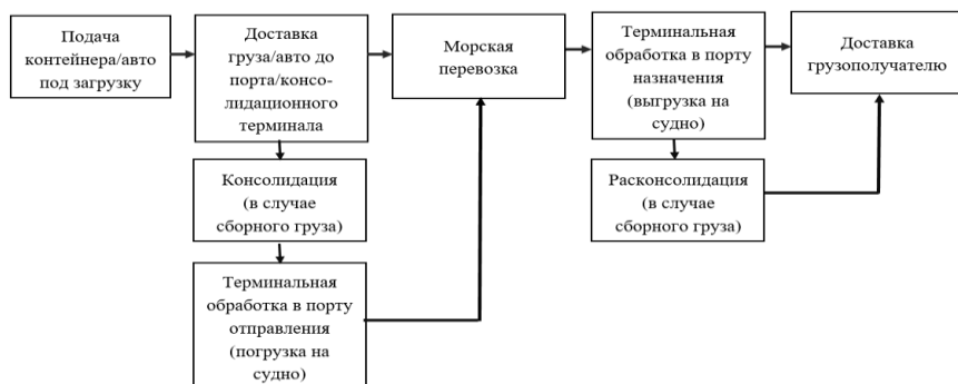
Рисунок 1 – Алгоритм мультимодальной перевозки комплектного и сборного груза с использованием автомобильного и морского транспорта
