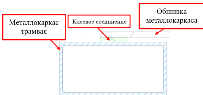
Рисунок 2 – Крепление обшивки трамвая на металлокаркасу
