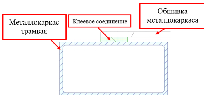
Рисунок 2 – Крепление обшивки трамвая на металлокаркасу
