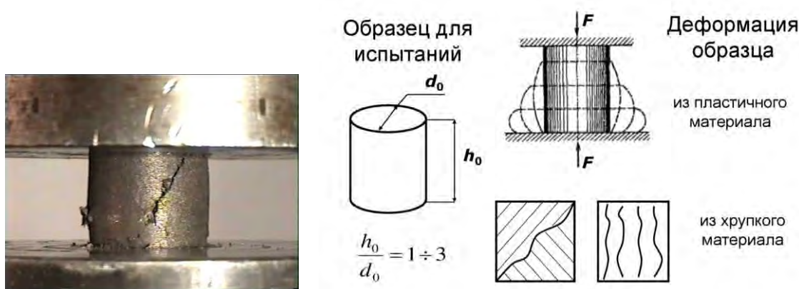
Рисунок 1.62 – Испытание на сжатие
