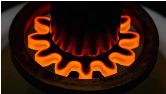
Рисунок 3.19 – Поверхностная закалка шестерни с использованием ТВЧ
