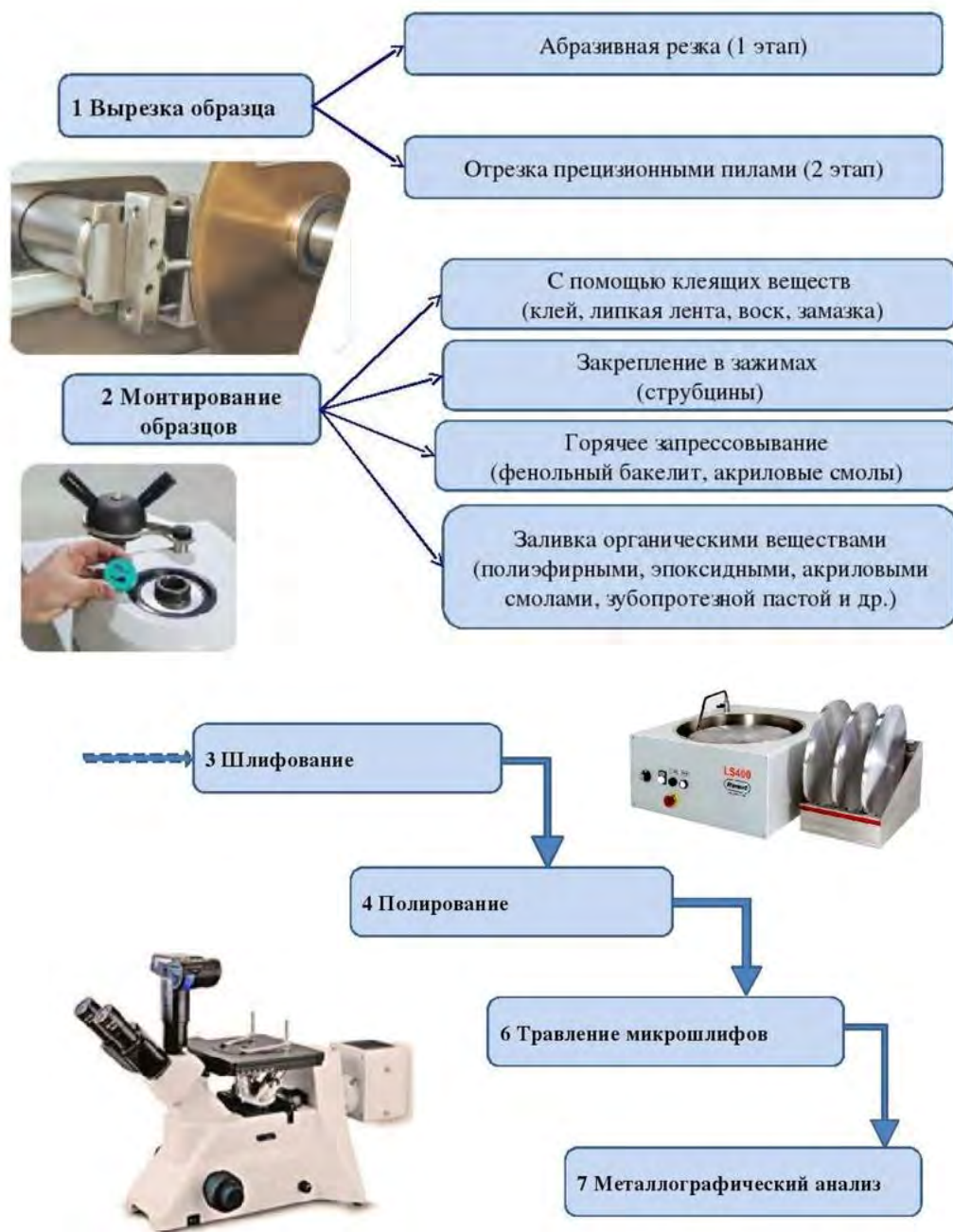
Рисунок 1.25 – Этапы процесса металлографии
