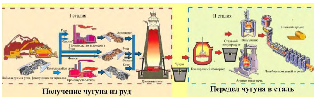
Рисунок 1.113 – Схема современного двухстадийного производства стали из руд
