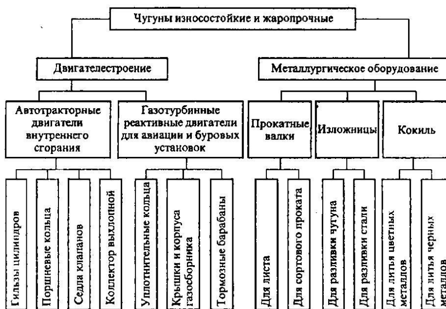
Рисунок 2.33 – Применение износостойких и жаропрочных чугунов
