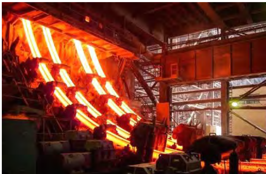
Рисунок 1.80 – Непрерывная разливка стали (4 ручья)
