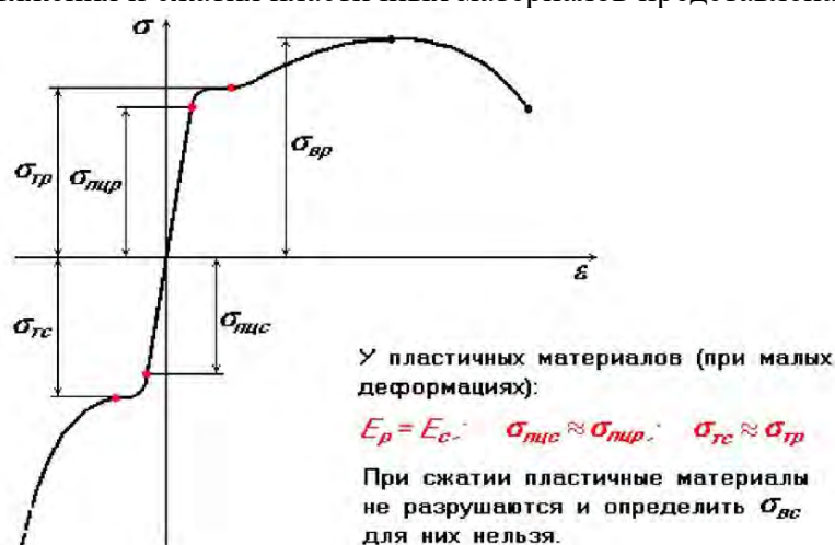
Рисунок 1.60 – Диаграмма растяжения и сжатия пластичных материалов
