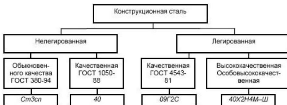
Рисунок 2.34 – Виды конструкционных нелегированных и легированных сталей, классифицируемых по качественным показателям
