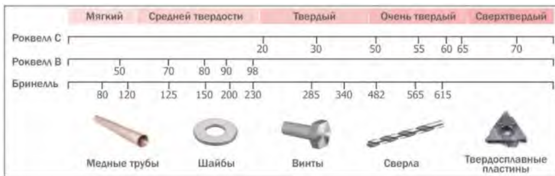
Рисунок 1.50 – Сравнительная шкала твердости по методам Роквелла и Бринелля и примеры изделий с различной твердостью
