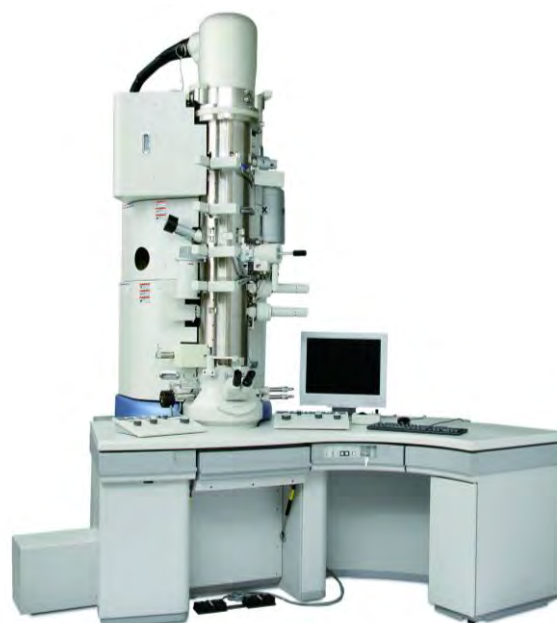
Рисунок 1.26 – Схема просвечивающей электронной микроскопии (ПЭМ)
