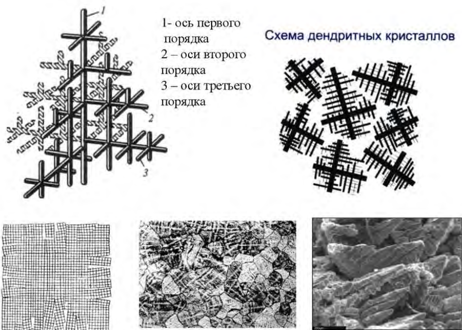
Рисунок 1.77 – Дендритный способ кристаллизации
