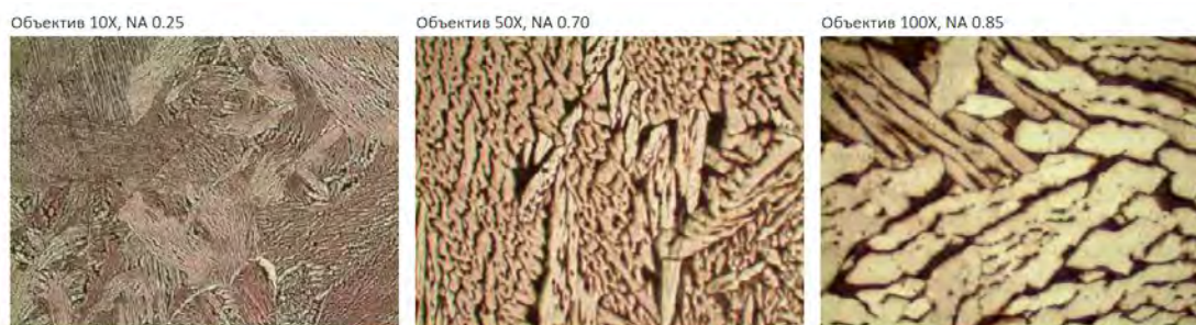
Рисунок 2.49 – Микроструктура латуни Л62
