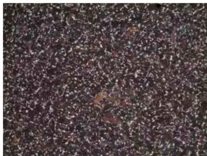
Рисунок 2.9 – Сталь 65 конструкционная рессорно-пружинная (показана при различном увеличении)
