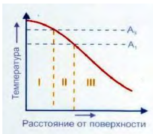
Рисунок 3.17 – Характерные зоны при поверхностной закалке
