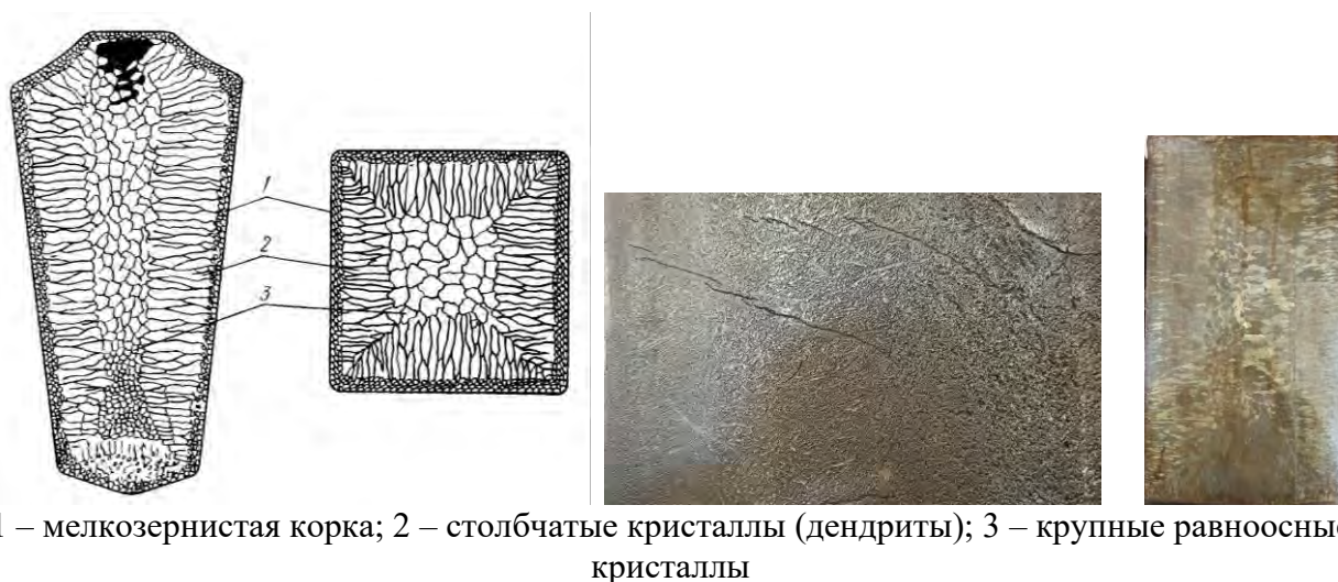
Рисунок 1.79 – Схема строения металлического слитка
