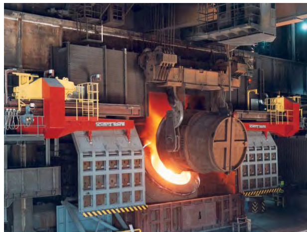
Рисунок 1.112 – Кислородный конвертер для получения стали из чугуна
