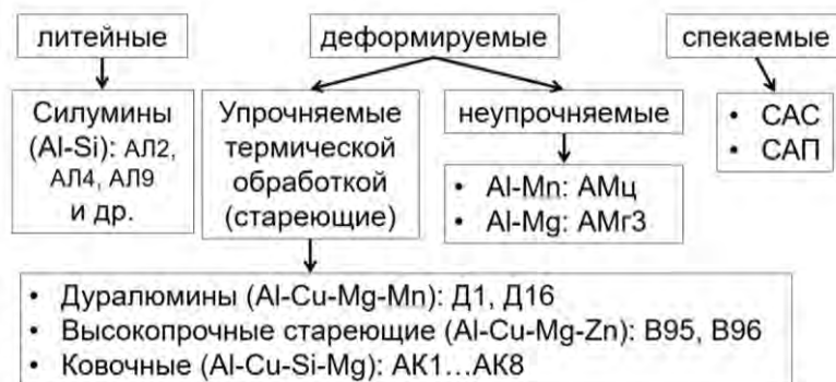
Рисунок 2.46 – Классификация алюминиевых сплавов по технологическим свойствам
