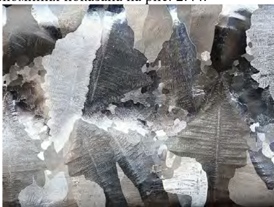
Рисунок 2.44 – Микроструктура литого алюминия
