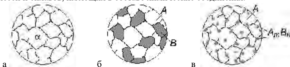
Рисунок 1.97 – Микроstructures твердых растворов, механических смесей и сплавов, имеющих в составе химические соединения
