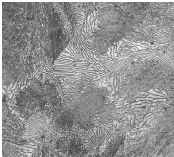
Рисунок 2.10 – Конструкционная пружинная (для силовых упругих элементов) сталь с содержанием углерода 0,8 %
