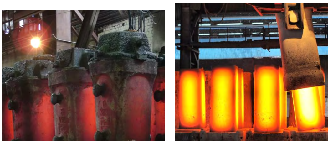
Рисунок 1.78 – Затвердевание слитков в изложницах и их извлечение из изложниц
