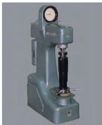
1 – оправка с индентором; 2 – предметный стол; 3 – грузы; 4 – электродвигатель Рисунок 1.40 – Схема твердомера Роквелла
