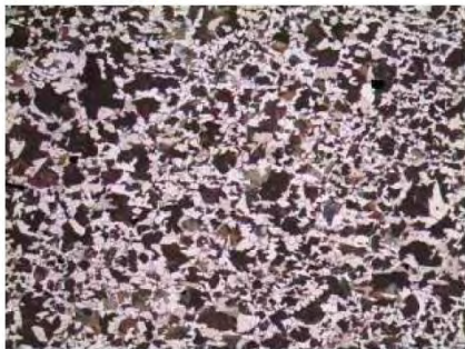
Рисунок 2.8 – Сталь 45 конструкционная углеродистая качественная (показана при различном увеличении)
