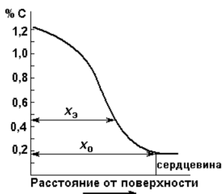
Рисунок 3.26 – Распределение углерода по сечению цементованных деталей
