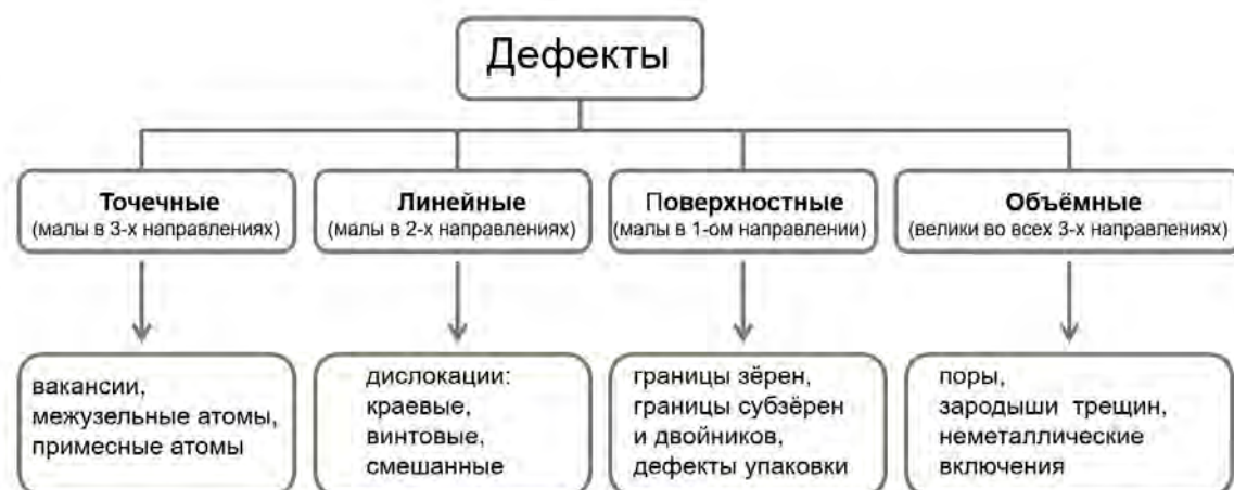
Рисунок 1.8 – Классификация дефектов кристаллического строения
