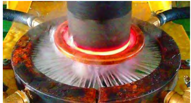
Рисунок 3.19 – Поверхностная закалка шестерни с использованием ТВЧ
