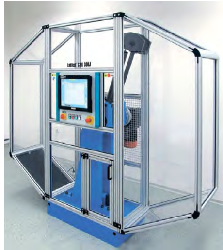
Рисунок 1.66 – Схема испытаний на маятничковом копре и современный вариант копра для испытаний
