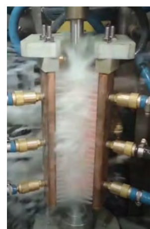
Рисунок 3.20 – Поверхностная закалка вала с использованием ТВЧ
