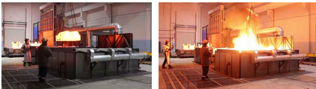
Рисунок 3.14 – Закалка в масло на термическом участке цеха компании ООО "Волга-СтальПроект"
