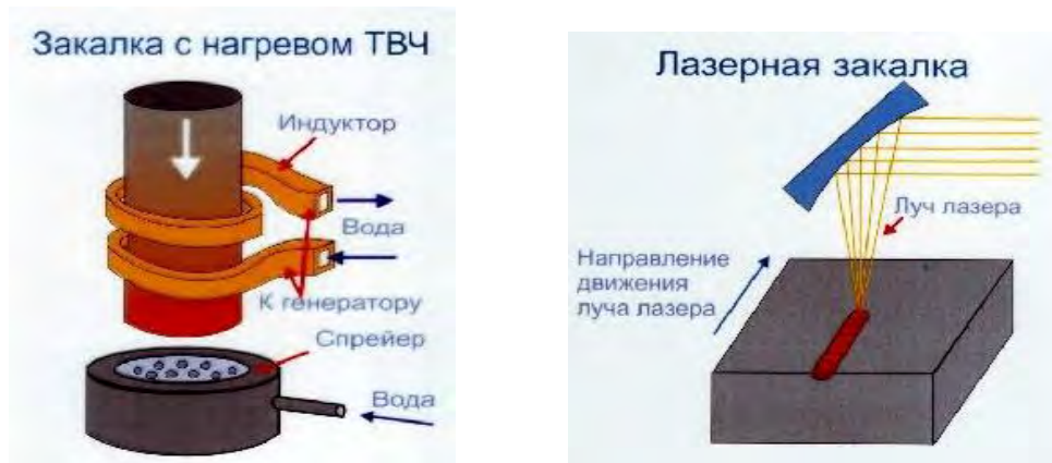
Рисунок 3.18 – Способы поверхностной закалки
