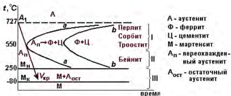
Рисунок 3.6 – Диаграмма изотермического превращения аустенита для стали с 0,8%С
