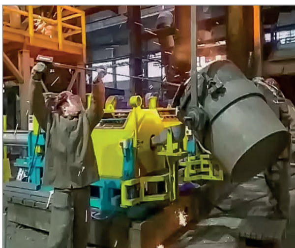
Рис. 7. Процесс первой заливки на новом оборудовании ОАО «БЕЛНИИЛИТ» на предприятии Российской Федерации
