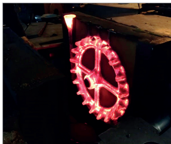
Рис. 8. Полученная отливка «Колесо кольчато-шпоровое» в облицованный кокиль на оборудовании ОАО «БЕЛНИИЛИТ»
