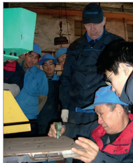
Рис. 6. Приемка машины вертикально-стопочной формовки модели 4812 и качества отпечатка песчано-глинистой формы представителями Заказчика из КНР. Изготовление отливок поршневых колец двигателя внутреннего сгорания
