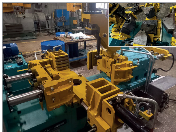
Рис. 2. Подготовленная к испытаниям кокильная машина модели 4992М с обеспечением шести движений для разборки оснастки и изготовления сложных по геометрии отливок в постоянные формы. Заказчик – предприятие РФ
