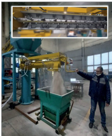
Рис. 5. Определение влияния углов атаки лопаток перемешивающего шнека в смесителе непрерывного действия СШ12 на форму факела выброса песчано-смоляной смеси
