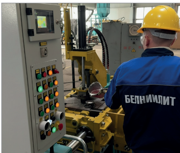
Рис. 9. Отработка технологии получения отливок из алюминиевых сплавов в ОАО «БЕЛНИИЛИТ» и сдача кокильной машины заказчику
