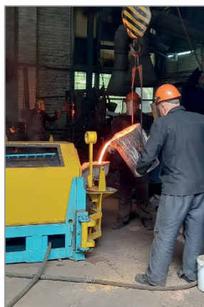
Рис. 1. Отработка оптимальных скоростей охлаждения, скоростей вращения и заливки при освоении новой отливки на центробежной машине модели 49100М в лаборатории
