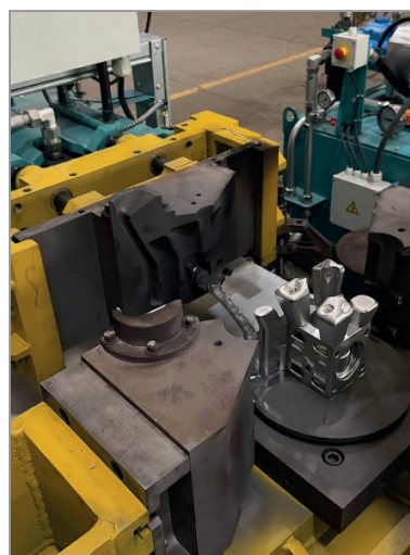
Рис. 9. Отработка технологии получения отливок из алюминиевых сплавов в ОАО «БЕЛНИИЛИТ» и сдача кокильной машины заказчику
