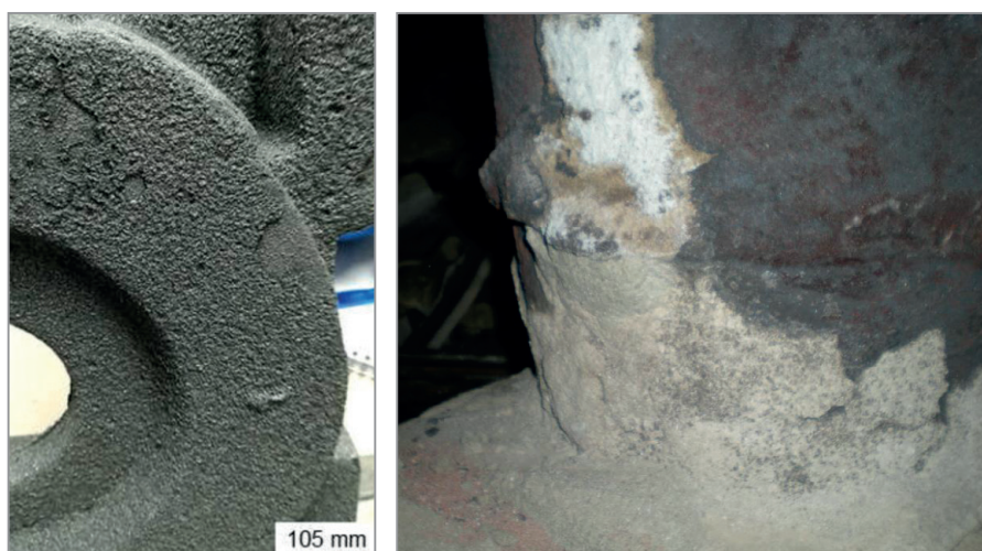
Рис. 7. Химический пригар на поверхности отливок
