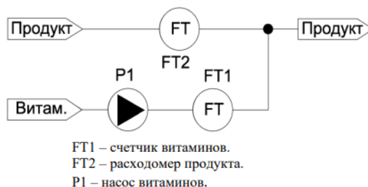
Рис.3. Мнемосхема установки дозирования витамина.
