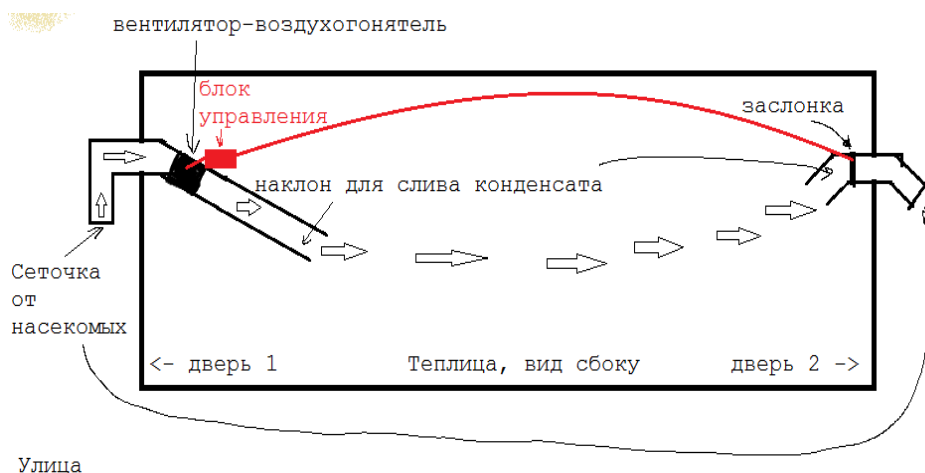
Рис.1. Пространственное размещение элементов системы воздухообмена в теплице.
