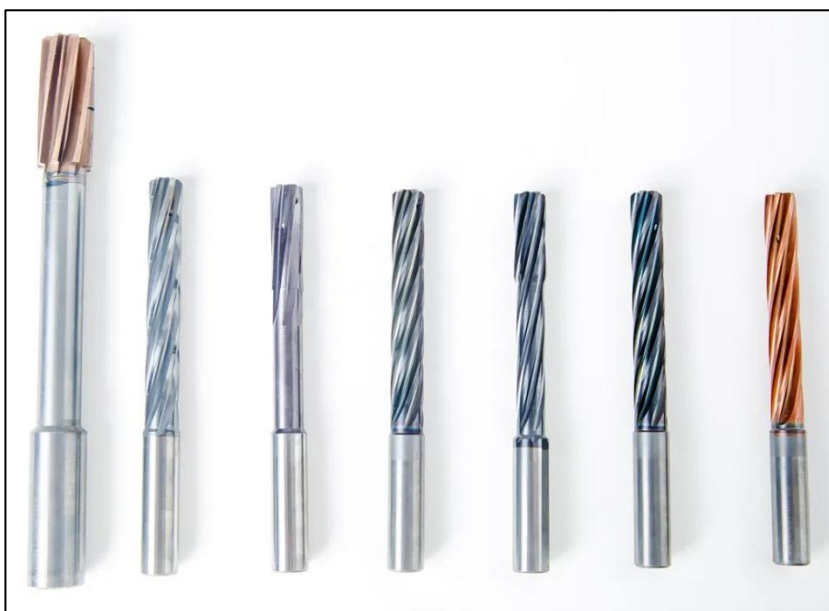
Рисунок 10 – Зенкеры с отверстиями для подвода СОЖ [17]
