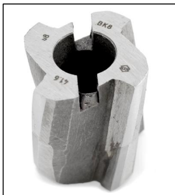
Рисунок 2 – Зенкер диаметром 41,6 мм типа 2 по ГОСТ 3231-71
