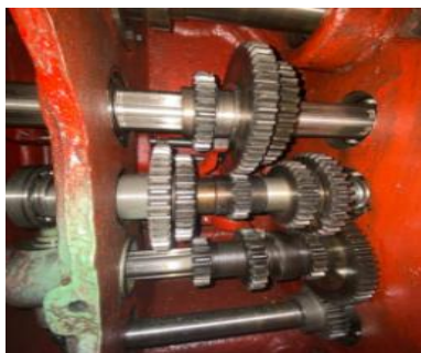
коробка скоростей ПГД станка (натурный образец)
