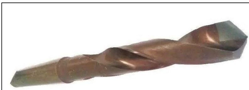
Рисунок 5 – Сверло диаметром 50 мм с припаянной пластиной из твёрдого сплава
