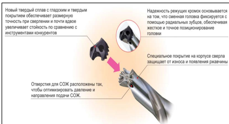
Рисунок 2 – Конструктивные особенности свёрл со сменными головками «Sumitomo»
