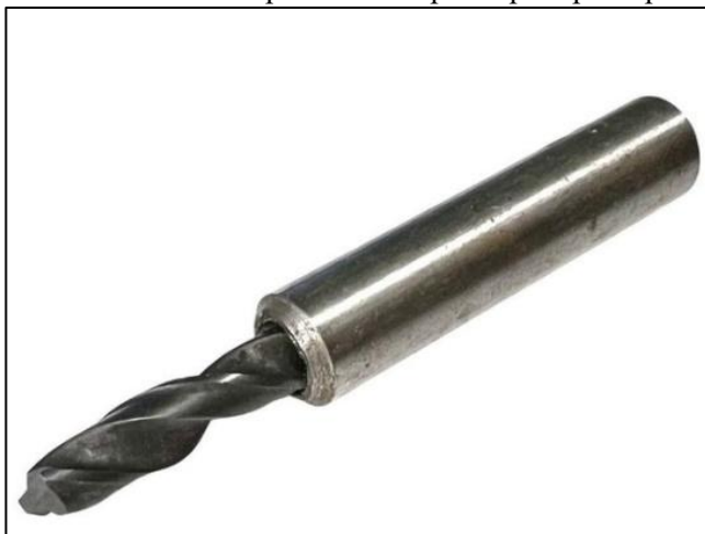
Рисунок 4 – Сверло диаметром 5,3 мм, с рабочей частью из твёрдого сплава, запрессованной в стальной цилиндрический хвостовик
