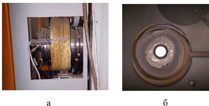
Рисунок 5 - Узел розжига (а) и место расположения катода-мишени (б)
