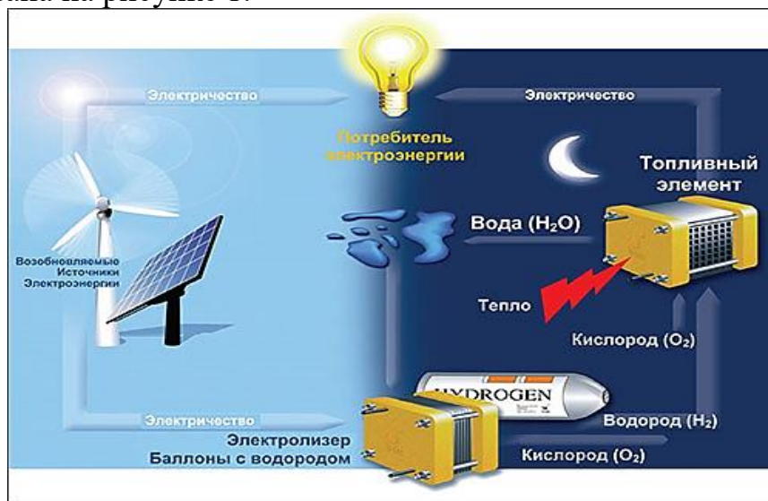
Рисунок 1 – Схема «водородного» цикла получения электроэнергии и тепла из ВИЭ для жилья
