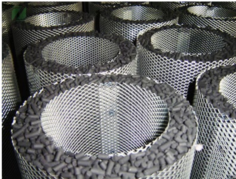
Рис. 4. Адсорбционные фильтры с активированным углем
