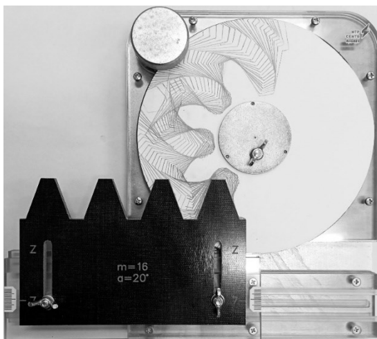
Рис. 2.2. Процесс нарезания зубчатого колеса без смещения инструмента
