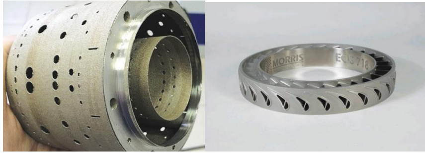
Рис. 13. Охлаждающий элемент и лопаточный ротор
