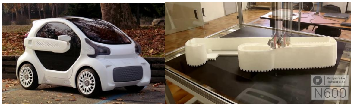
Рис. 11 – Электрокар, напечатанный с помощью 3D-принтера
