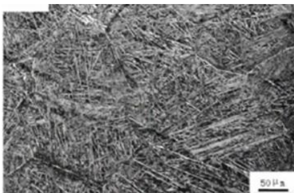
Рисунок 3 – Структура сплава TA15 при температуре экструзии в 1050 °C
