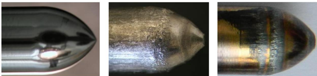
Рисунок 1 – Сравнение изношенного пуансона, пуансона после ХТО и нанесения покрытия
