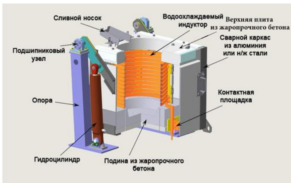
Рисунок 1 – Строение индукционной печи
