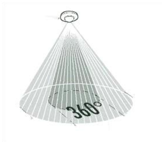
Рисунок 7 - Направление лучей датчика движения
