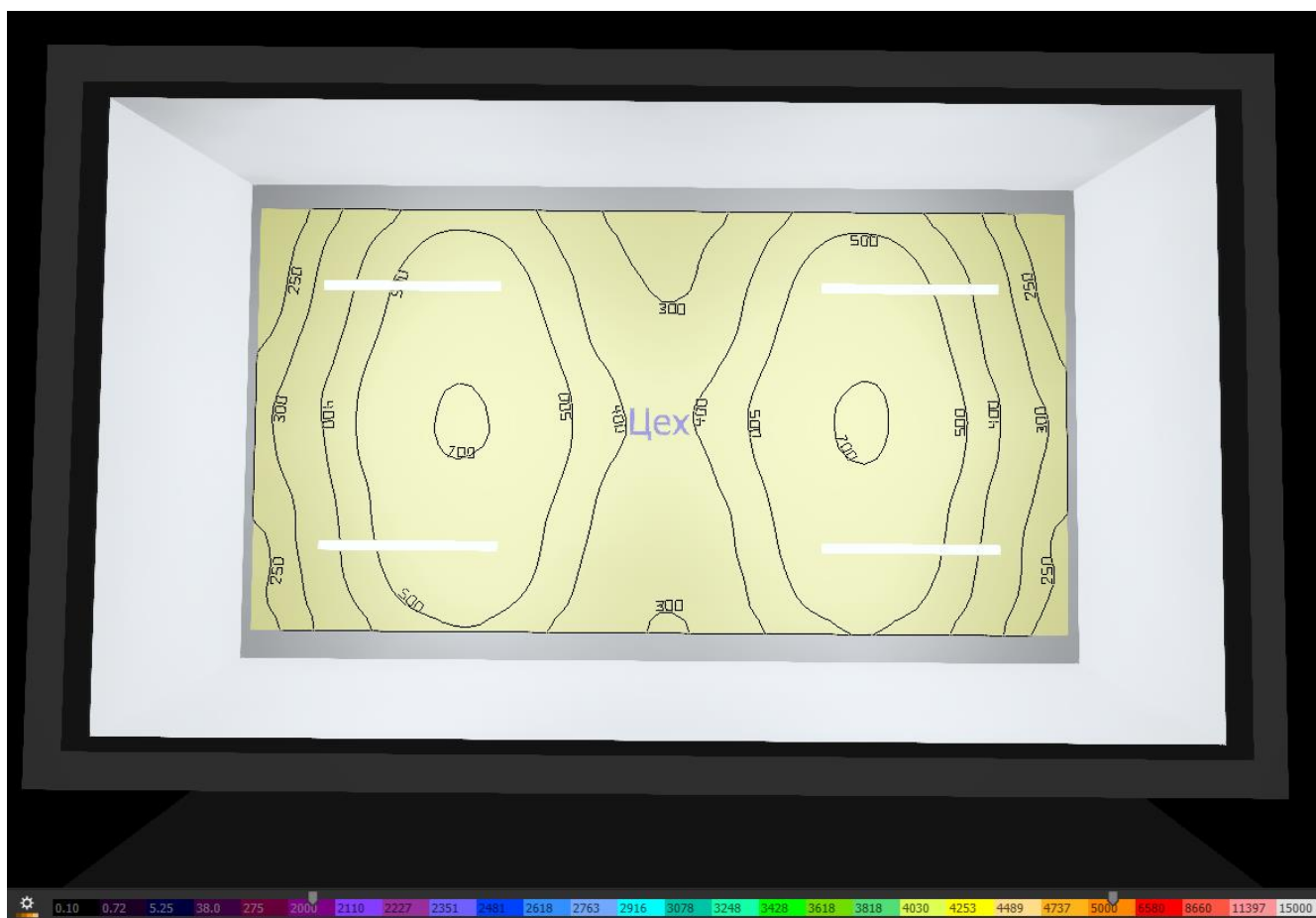
Рисунок 1 – Результаты светотехнического расчёта цеха со светильниками WT120C
