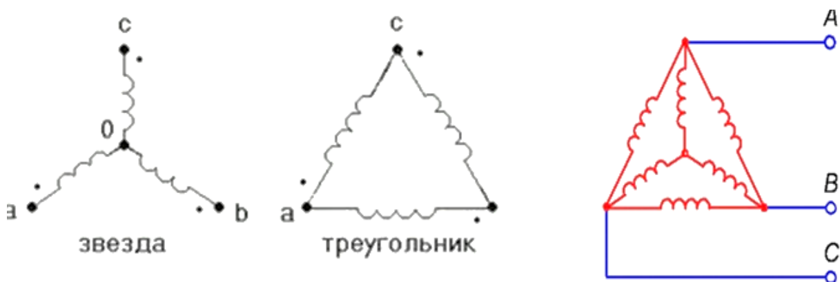
Рисунок 1 – Схемы обмотки «звезда», «треугольник», «совмещенная»
