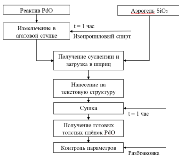
Рис. 1. Технологическая схема получения пленок PdO путем золь-гель метода
