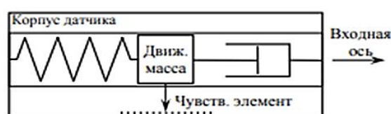
Рис. 1. Принцип действия МЭМС сенсора ускорения
