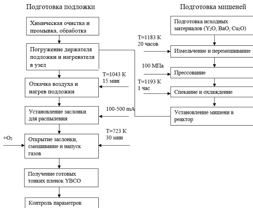
Рис. 1. Технологическая схема получения сверхпроводящих керамических слоев
