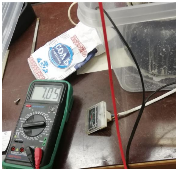
Рисунок Б5 - Начало кипения температуре 70^{\circ}\text{C} и соответственно испарение раствора, U = 7
