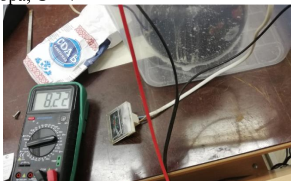
Рисунок Б6 - Кипение при температуре 80^{\circ}\text{C} и соответственно испарение раствора, U = 8
