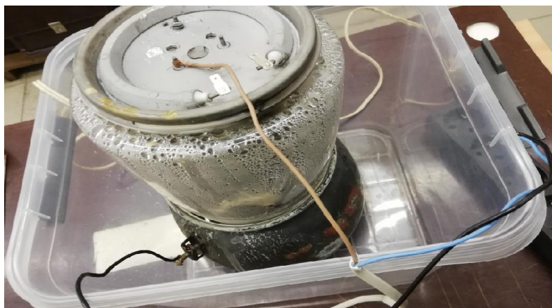
Рисунок Б3 - Макет для измерения проводимости пара насыщенного соляного раствора получаемого за счет кипячения воды с растворенной в ней солью.
