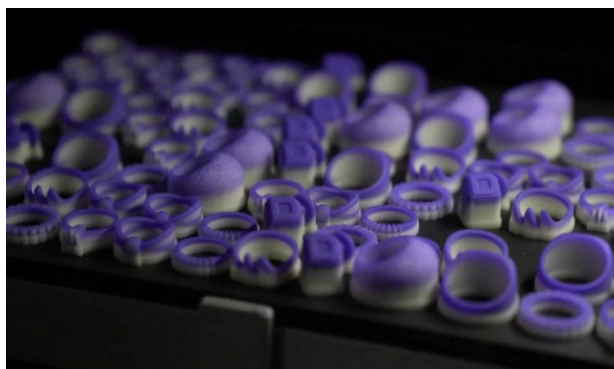
Рис. 4.3. Общий вид моделей с восковыми поддержками
