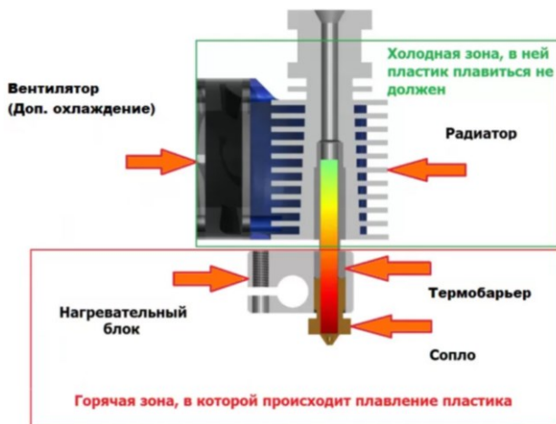
Рис. 2.3. Температурная схема экструдера (хотенда)
