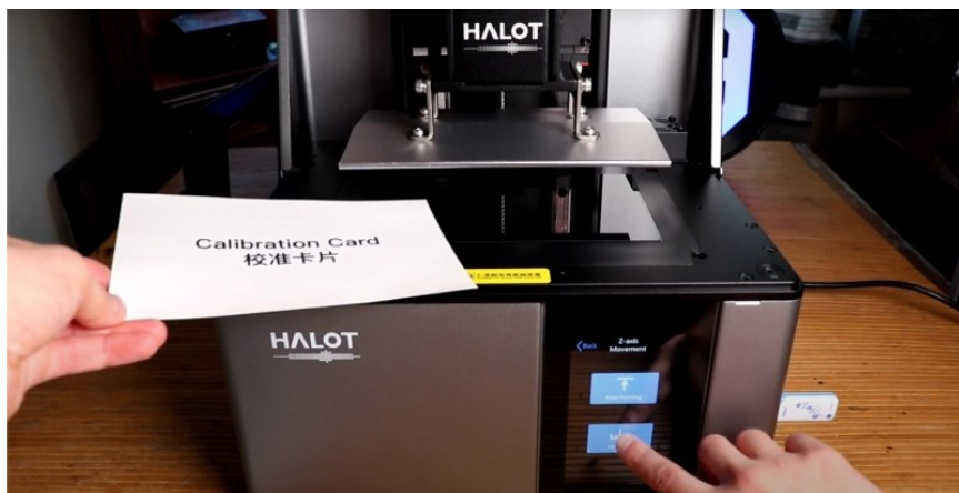
Рис. 6.4. Процесс калибровки фотополимерного принтера
