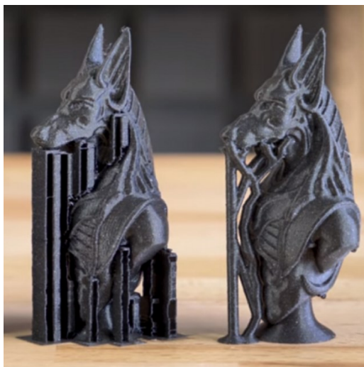
Рис. 3.3. Общий вид поддерживающих структур модели
