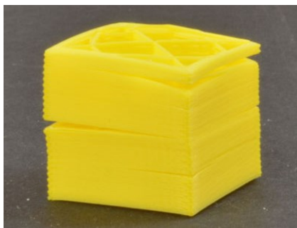
Рис. 5.6. Расслоение модели во время печати
