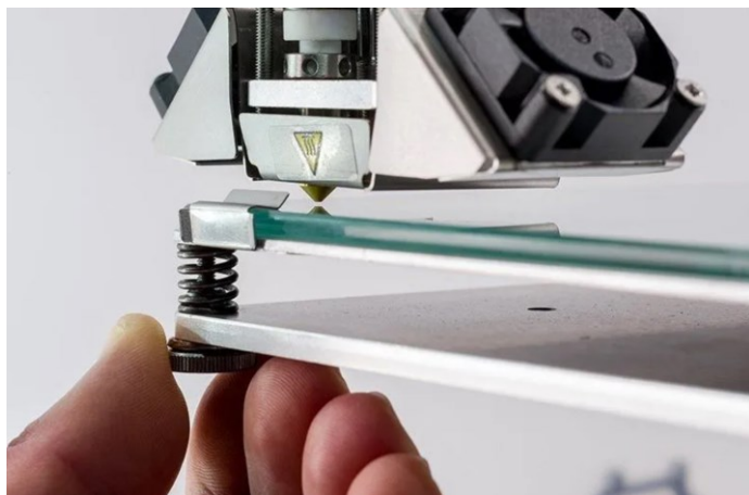
Рис. 3.1. Общий вид винта, регулирующего зазор в процессе калибровки
