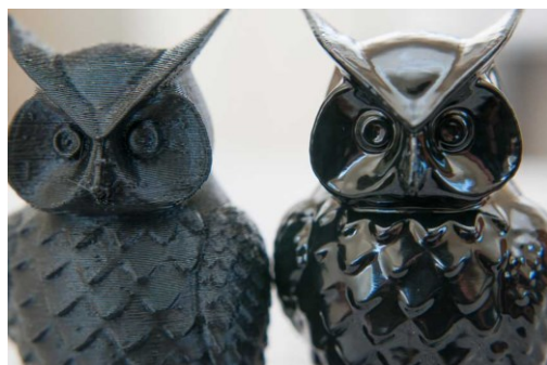
Рис. 4.4. Модель до (слева) и после (справа) обработки парами ацетона
