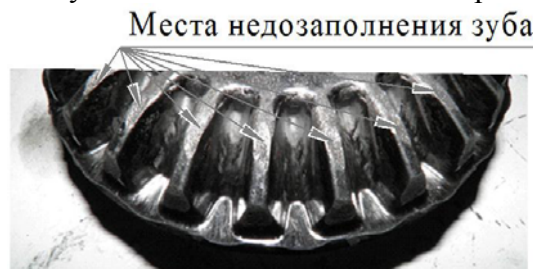
Рисунок 2 – Внешний вид зубчатого венца на 2 переходе штамповки
