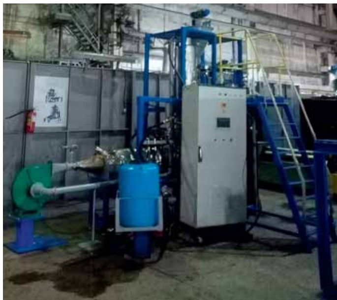
📷 6 Установка совместного пиролиза возобновляемого растительного сырья, тяжелых нефтяных остатков
