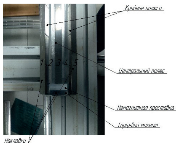
Рис. 8. Изготовленная магнитная система цилиндрического магнетрона: 1, 2, 3, 4, 5 – линии измерения; 1, 5 – крайние полюса; 2, 4 – линии трека; 5 – линия центрального полюса
