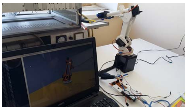
Рисунок 7 – Система управления роботом на основе 3D моделирования и действующий макет промышленного робота
