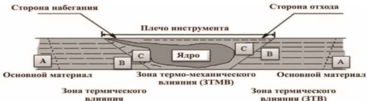
Рисунок 2 – Структура сварного шва [2]
