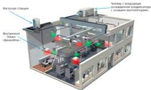
Рис. 1. Система кондиционирования чиллер-фанкойл
