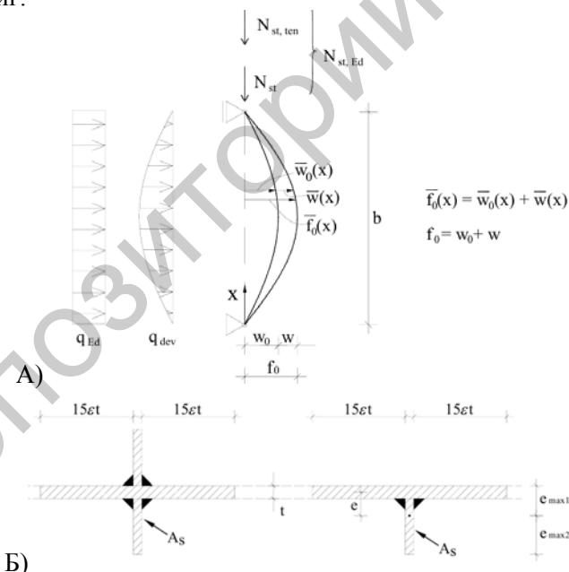
Рисунок 2 – К расчету поперечного ребра жесткости:
