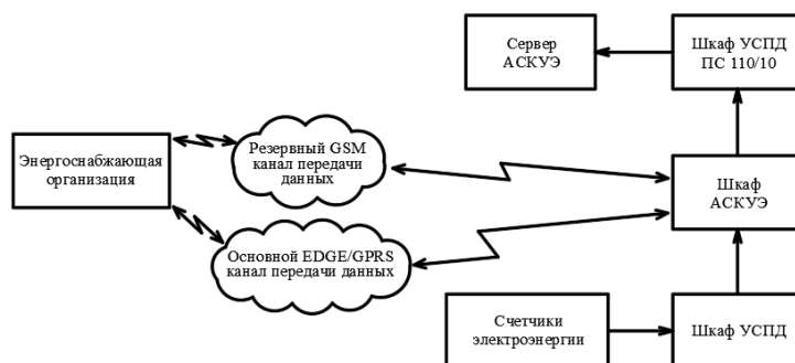
Рисунок 2 – Упрощенная структурная схема АСКУЭ
