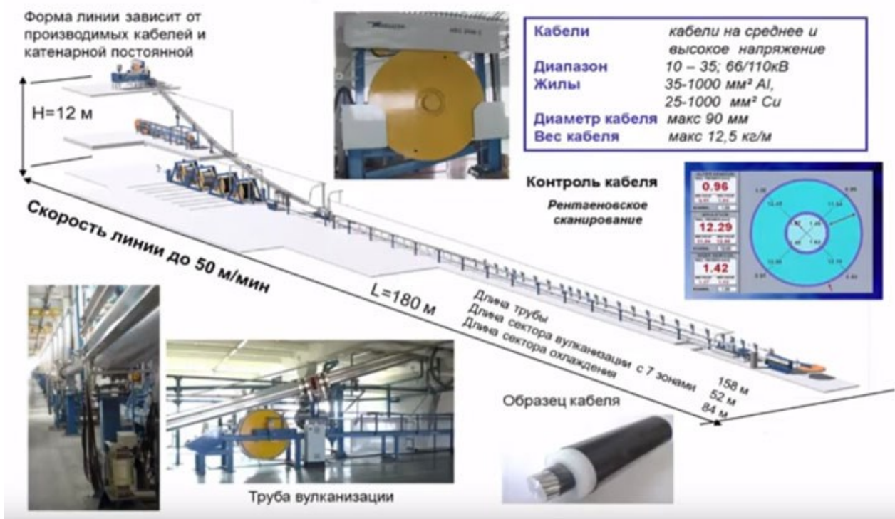
Рисунок 3–Производство кабеля из сшитого полиэтилена
