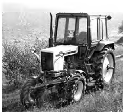
Рисунок 5. Трактор «Беларусь» с изменяемой геометрией ходовой системы для работы в условиях пересеченной и горной местности (во время испытаний на полигоне МГЗ, д. Абчак, Минский р-н)
