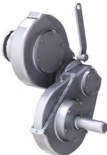
Рисунок 2. Сдвоенный бортовой редуктор в крайнем рабочем положении его составных частей, обеспечивающих перемещение колеса по высоте
